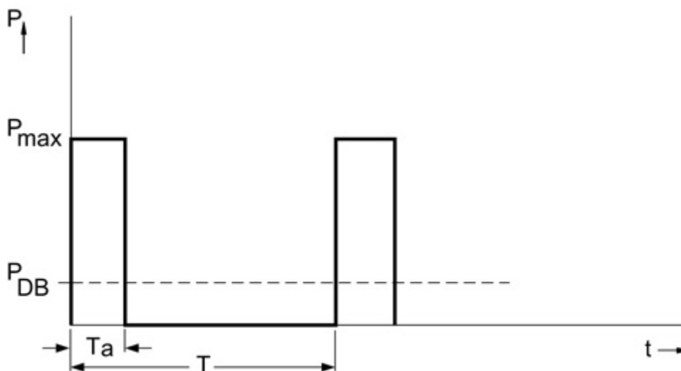
Abb. 19 Belastungsdiagramm für Bremswiderstand Bauform Blocksize
